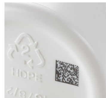
System laserowy Videojet 7810 tworzy trwałe oznakowania wysokiej rozdzielczości na opakowaniach z tworzywa HDPE z zastosowaniem fal UV
